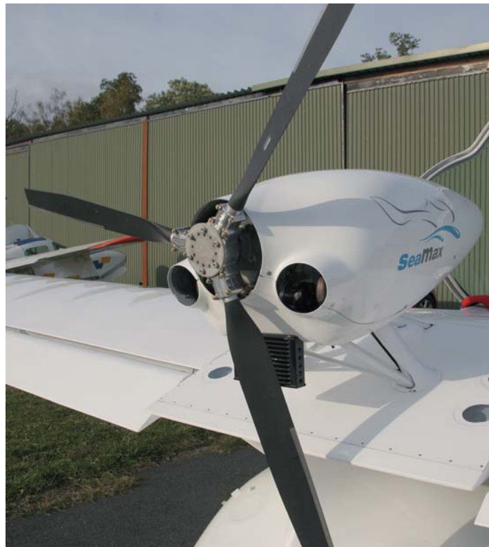
Bilderna ovan: Med klaff ute sjunker SeaMax enkelt in för landning även över höga masker vid stranden. T v: Motorgondolen med en Rotax 912S på 100 hp och en 68 tums trebladig snurra med warpdrive. Startklaff är utfälld. Nedan det infällbara landstället.
