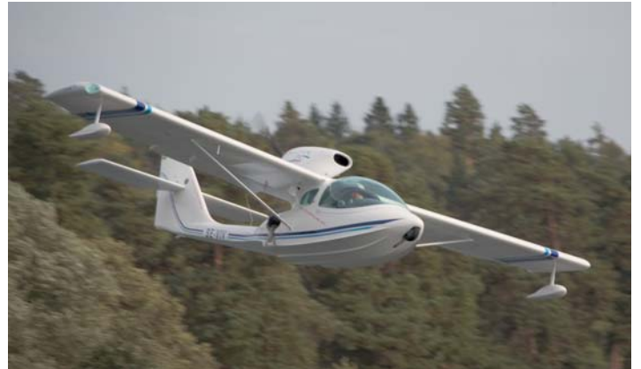
Bilderna ovan: Med klaff ute sjunker SeaMax enkelt in för landning även över höga masker vid stranden. T v: Motorgondolen med en Rotax 912S på 100 hp och en 68 tums trebladig snurra med warpdrive. Startklaff är utfälld. Nedan det infällbara landstället.
