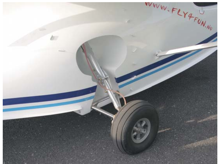
Bilderna ovan: Med klaff ute sjunker SeaMax enkelt in för landning även över höga masker vid stranden. T v: Motorgondolen med en Rotax 912S på 100 hp och en 68 tums trebladig snurra med warpdrive. Startklaff är utfälld. Nedan det infällbara landstället.
